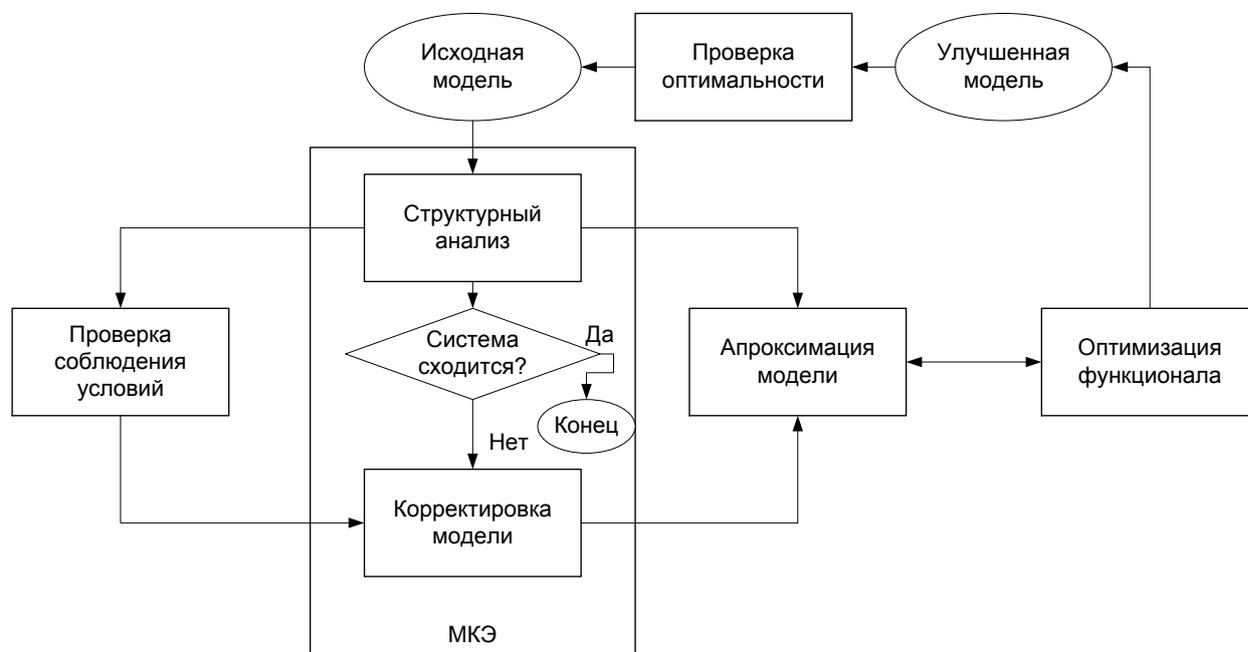
Рис. 1 Структурная схема процесса оптимизации технологии
